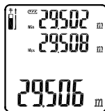
Kontinuierliche Distanzmessung mit Minimum- und Maximumwert.
