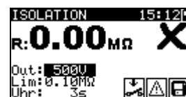
Bild 5.10: Beispiele von Ergebnissen der Isolationswiderstandsmessung
