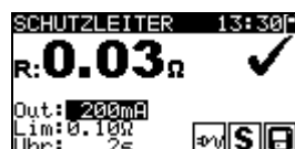
Bild 5.7: Beispiele von Ergebnissen der Schutzleiterwiderstand-Durchgangswiderstandsmessung
