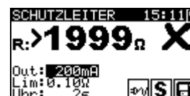
Bild 5.7: Beispiele von Ergebnissen der Schutzleiterwiderstand-Durchgangswiderstandsmessung
