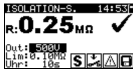
Bild 5.13: Beispiele von Ergebnissen der Isolationswiderstandsmessung-S
