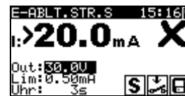
Bild 5.19: Beispiele von Ergebnissen der Messung des Ersatzableitstroms-S
