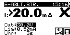
Bild 5.16: Beispiele von Ergebnissen der Messung des Ersatzableitstroms
