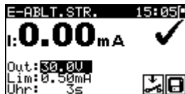
Bild 5.16: Beispiele von Ergebnissen der Messung des Ersatzableitstroms
