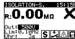
Bild 5.13: Beispiele von Ergebnissen der Isolationswiderstandsmessung-S
