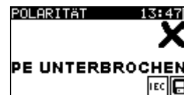
Bild 5.22: Beispiele für Polaritätsprüfungsergebnisse
