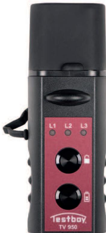
Der Testboy TV 950 ist ein EVSE-Ladesäulentester, welcher die wichtigsten Funktionen der Ladesäule im Handumdrehen überprüft, um ein sicheres Laden zu gewährleisten. Dieser Schnelltester simuliert ein ladebereites Fahrzeug, überprüft die Steckerverriegelung und zeigt zudem die anliegenden Phasen per LED-Anzeige an.
