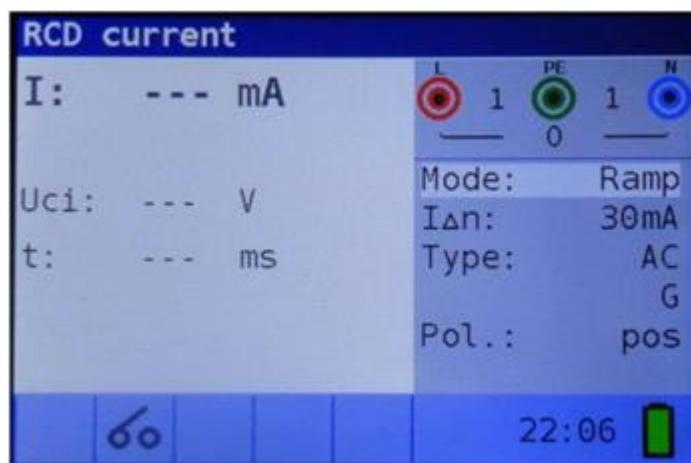
Image 5.17: Menu de mesure du courant de déclenchement
