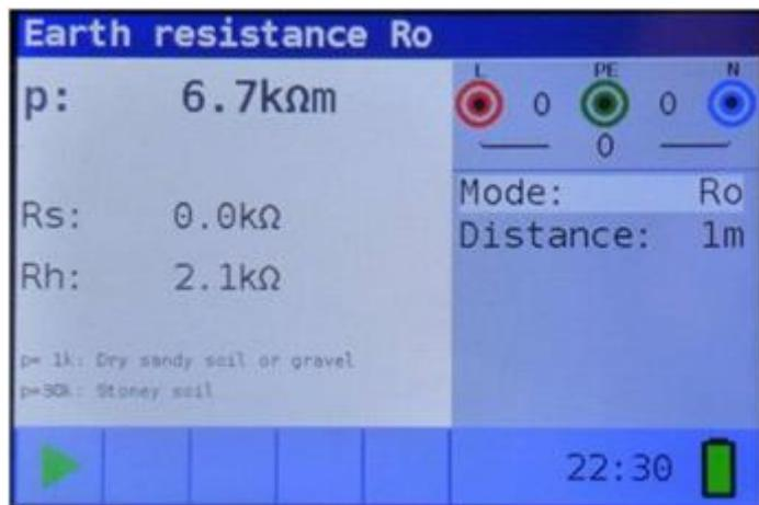
Imagen 5.52: Ejemplo de resultados de la medición de la resistividad de la tierra
