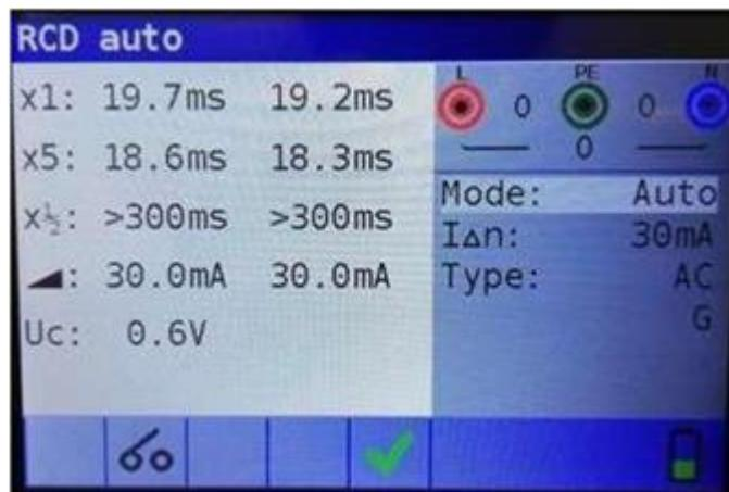
Imagen 5.27: Paso 8: resultados de la prueba automática de RCD
