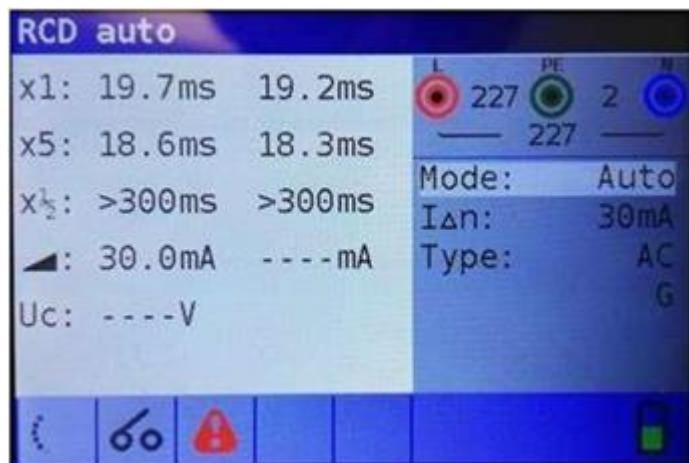
Imagen 5.26: Paso 7: resultados de la prueba automática de RCD
