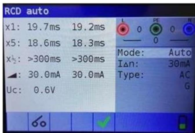
Foto 5.27: Stap 8 automatische RCD-testresultaten
