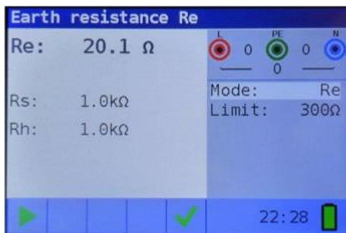
Image 5.49: Exemple de résultats d'une mesure de résistance de la terre
