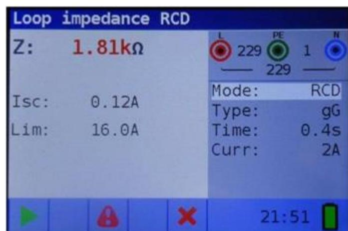
Foto 5.32: Voorbeeld van resultaten van lusimpedantiemeting RCD
