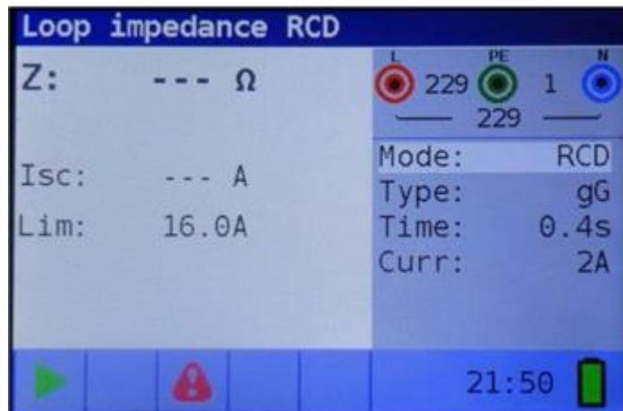
Imagen 5.31: Menú de la impedancia del bucle RCD
