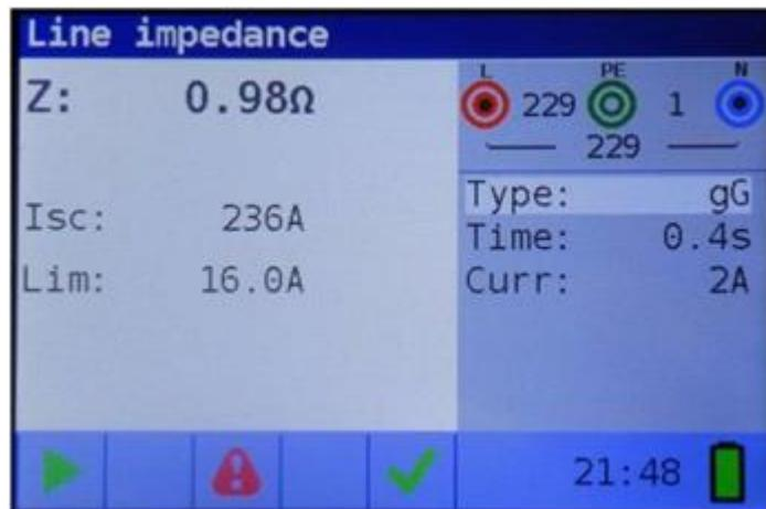
Foto 5.37: Voorbeeld van de resultaten van de lijnimpedantiemeting
