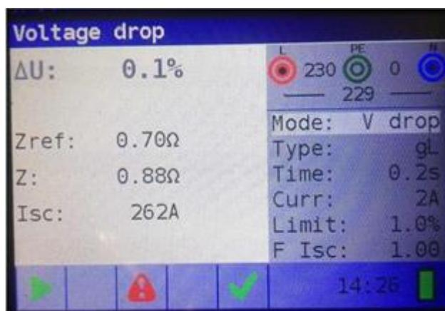
Immagine 5.39: Esempio di risultati di misura della caduta di tensione
