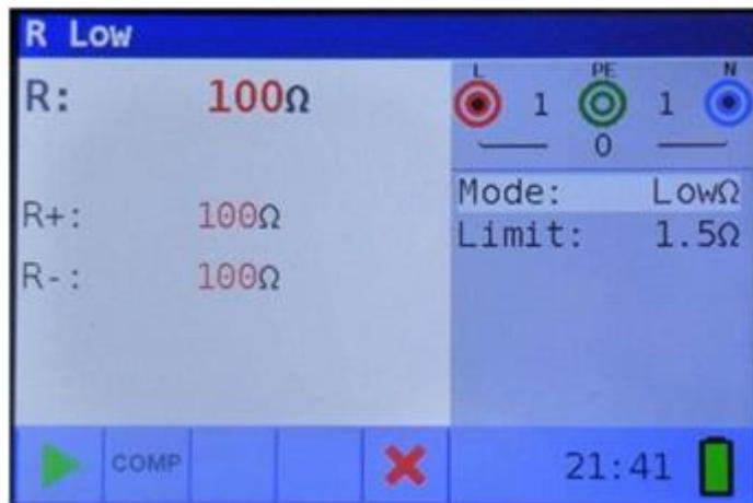
Imagen 5.7: Cables de prueba en cortocircuito
