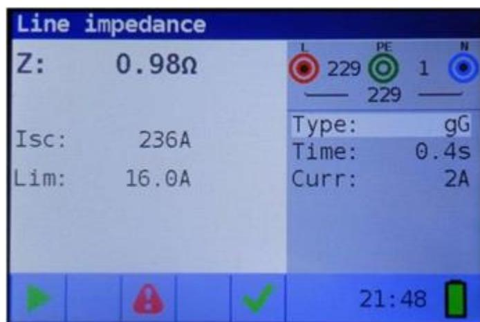
Image 5.37: Exemple de résultats de mesure d'impédance de ligne
