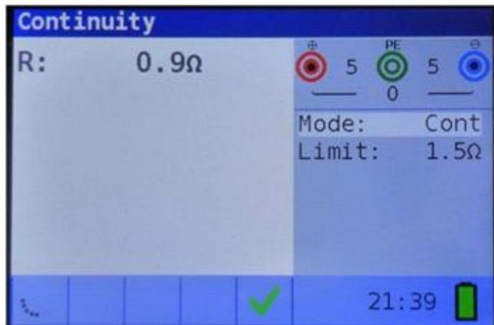
Imagen 5.10: Ejemplo del resultado de una medición de continuidad de baja intensidad
