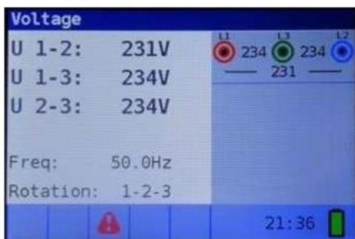
Immagine 5.42: Esempio di risultato di un test di sequenza di fase
