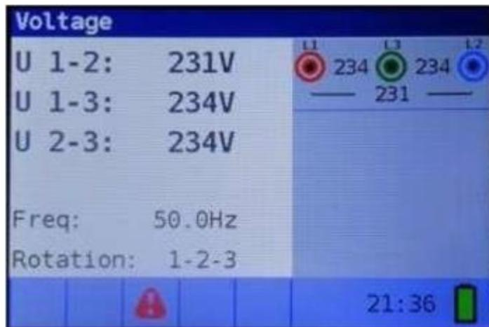
Image 5.42: Exemple de résultat de test de séquence de phases
