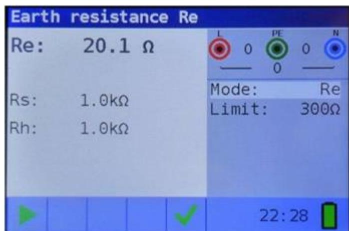
Imagen 5.49: Ejemplo de resultados de una medición de resistencia de tierra
