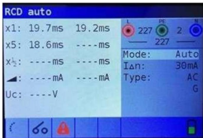
Foto 5.22: Stap 3 automatische RCD-testresultaten
