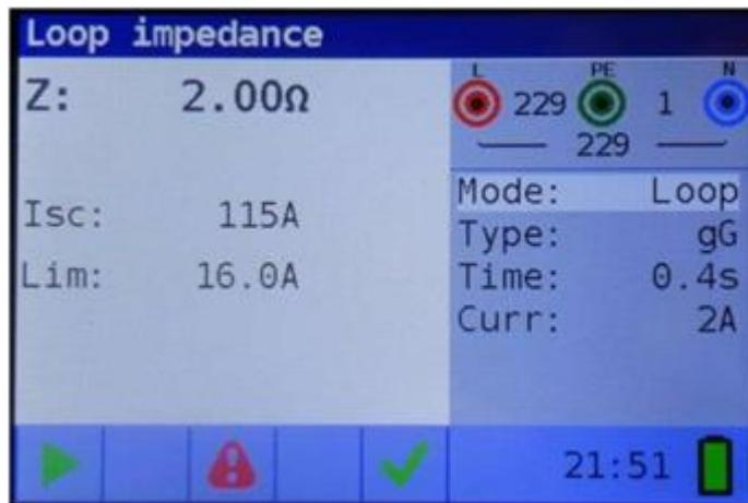
Imagen 5.30: Ejemplo de los resultados de la medición de la impedancia del bucle
