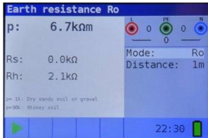
Image 5.52: Exemple de résultats de la mesure de la résistivité du sol
