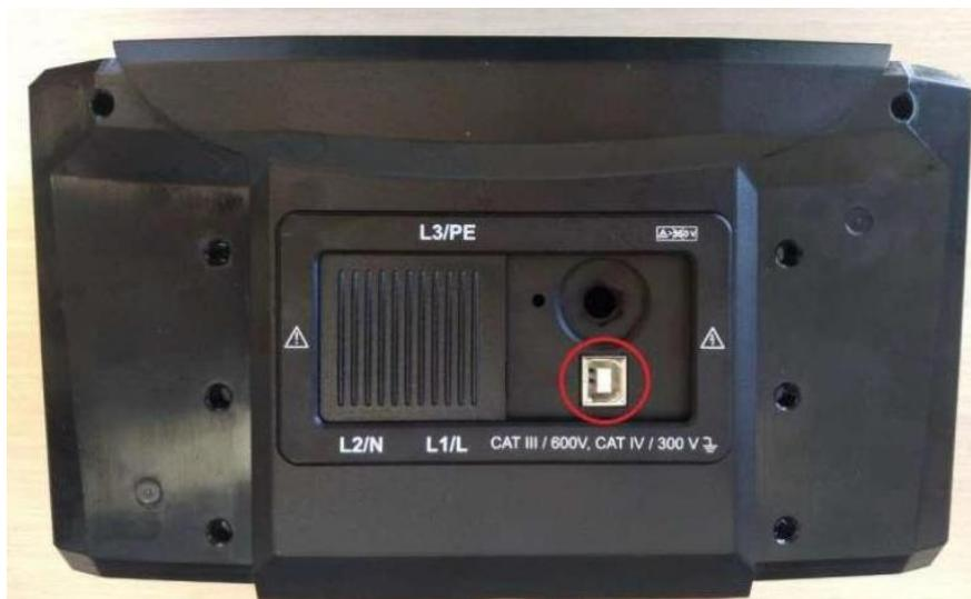
Foto 9.1: De USB-poort op de bovenkant van het toestel
