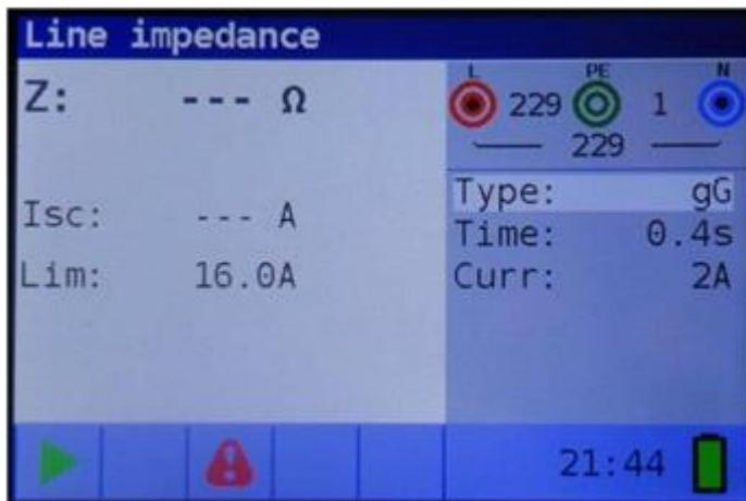
Foto 5.35: Menu voor het meten van de lijnimpedantie
