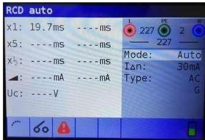
Foto 5.20: Stap 1 automatische RCD-testresultaten
