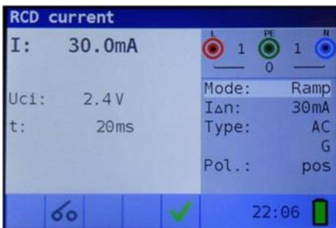
Imagen 5.18: Ejemplo del resultado de la medición de la corriente de disparo
