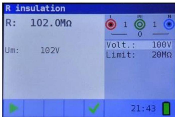
Immagine 5.3: Esempio di misurazione della resistenza di isolamento
