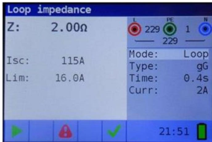
Image 5.30: Exemple de résultats de mesure d'impédance de boucle
