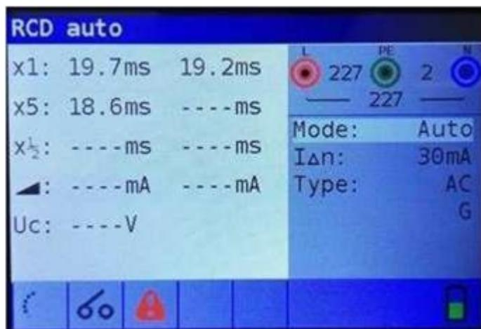
Immagine 5.22: Risultati del test RCD automatico di Passo 3
