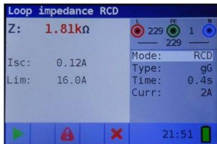
Image 5.32: Exemple de résultats de mesure d'impédance de boucle RCD
