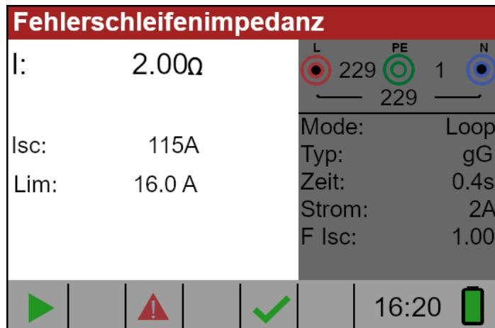
Bild 5.30: Beispiel für die Ergebnisse der Schleifenimpedanzmessung
