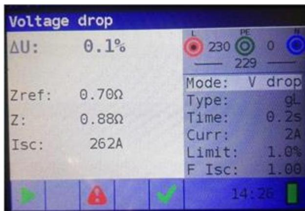
Image 5.39: Exemple de résultats de mesure de la chute de tension
