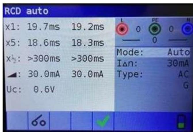
Immagine 5.27: Passo 8 risultati del test RCD automatico
