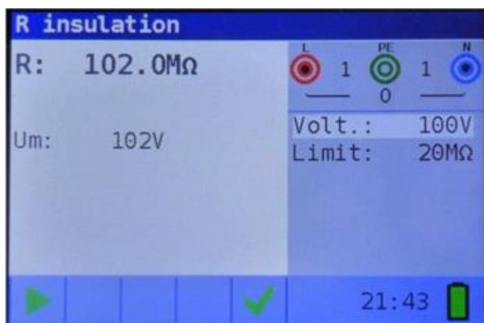
Image 5.3: Exemple de mesure de la résistance d'isolement
