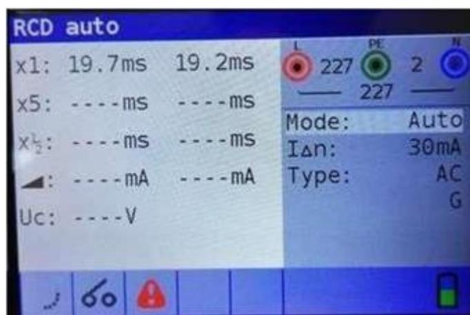
*Imagen 5.21: Paso 2: resultados de la prueba automática de RCD*
