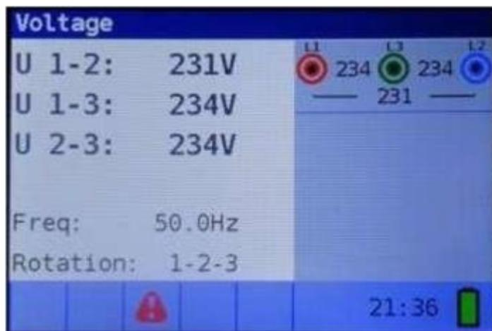
Imagen 5.42: Ejemplo de resultado de una prueba de secuencia de fases
