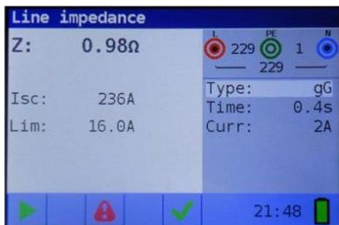
Imagen 5.37: Ejemplo de los resultados de la medición de la impedancia de la línea
