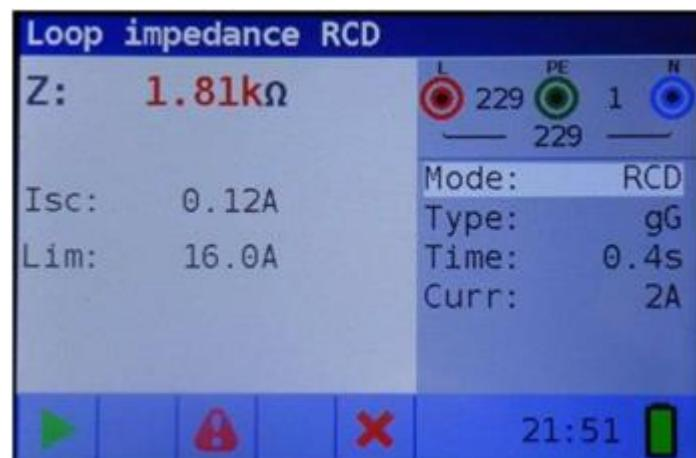
Immagine 5.32: Esempio di risultati della misurazione dell'impedenza del loop RCD
