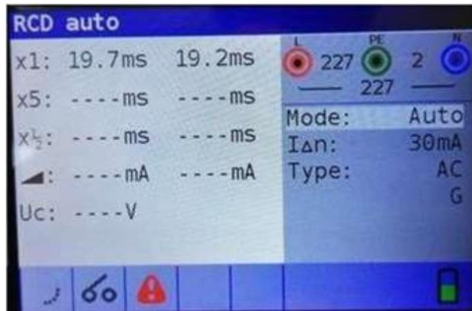
Immagine 5.21: Risultati del test RCD automatico della Passo 2
