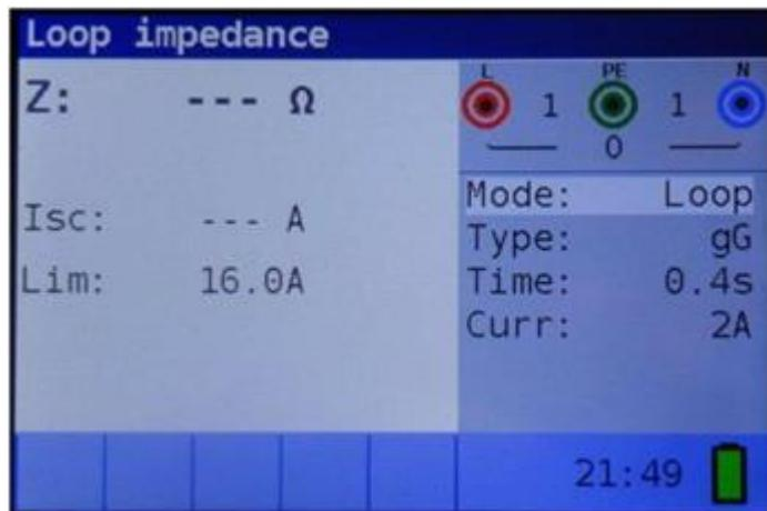
Imagen 5.28: Menú de medición de la impedancia de bucle
