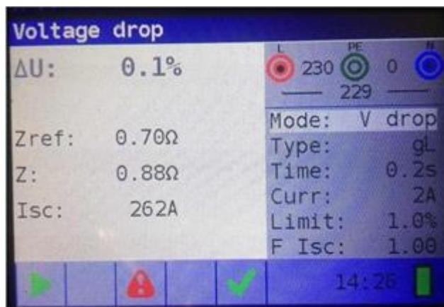
Foto 5.39: Voorbeeld van de meetresultaten van de spanningsvalmeting
