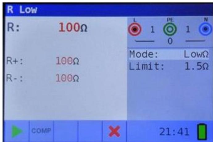
Foto 5.7: Kortgesloten testsnoeren
