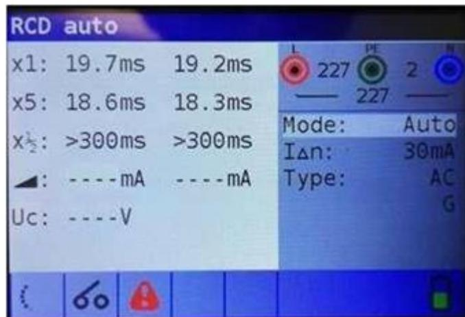
Image 5.25: Étape 6 résultats de test RCD automatique
