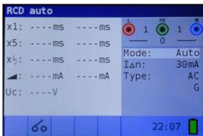
Imagen 5.19: Menú de prueba automática de RCD
