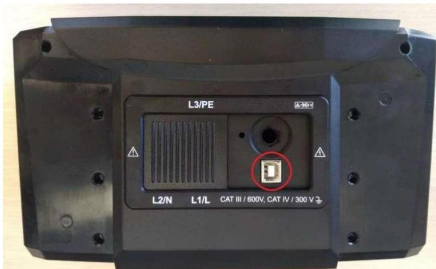
Bild 9.1: Der USB Anschluss auf der Oberseite des Gerätes
