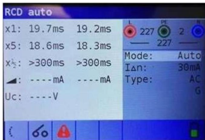
Imagen 5.25: Paso 6: resultados de la prueba automática de RCD
