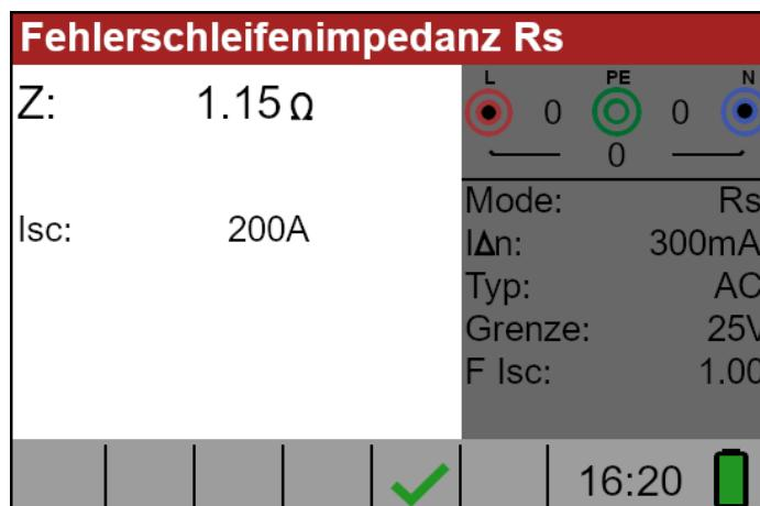
Bild 5.34: Beispiel für Ergebnisse der Schleifenimpedanzmessung RS
