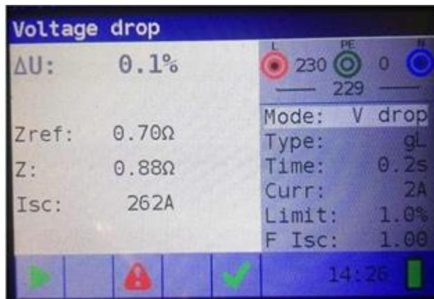
Imagen 5.39: Ejemplo de resultados de la medición de la caída de tensión
