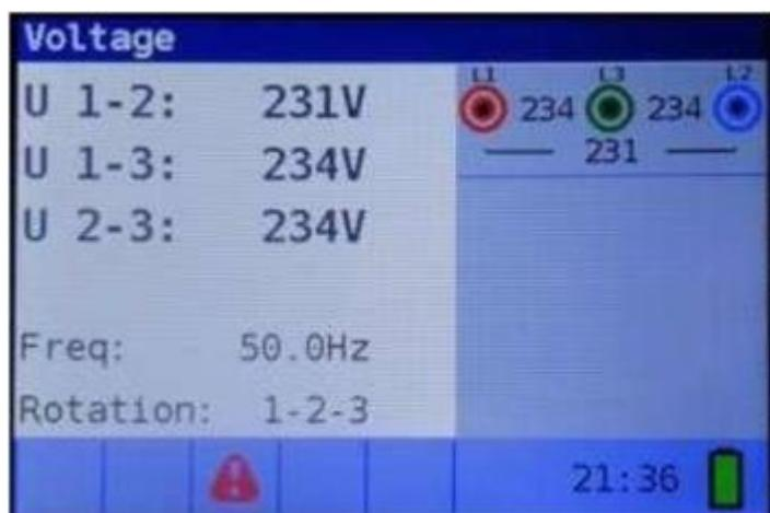
Foto 5.42: Voorbeeld van een testresultaat van een fasenvolgorde
