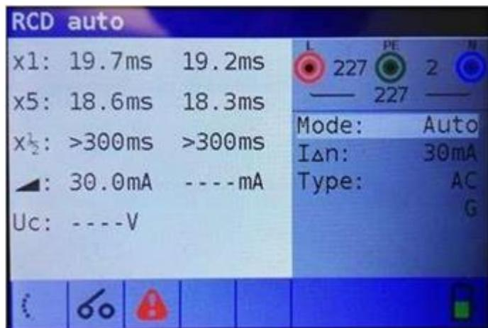
Foto 5.26: Stap 7 automatische RCD-testresultaten
