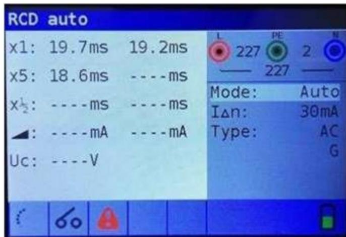
Image 5.22: Étape 3 résultats de test RCD automatique
