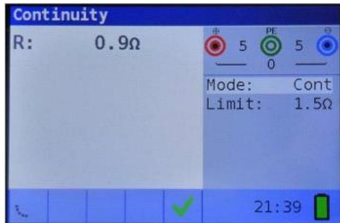
Image 5.10: Exemple de résultat d'une mesure de continuité à faible intensité
