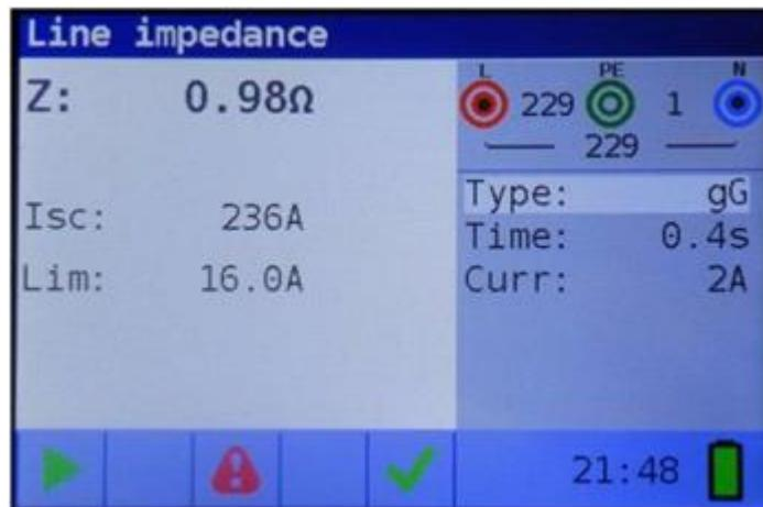
Immagine 5.37: Esempio di risultati della misura dell'impedenza di linea
