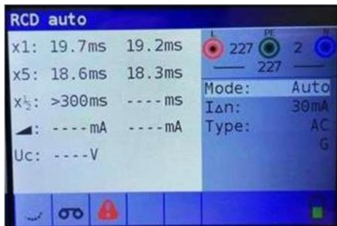
Imagen 5.24: Paso 5: resultados de la prueba automática de RCD
