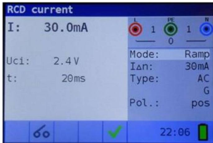
Image 5.18: Exemple de résultat d'une mesure de courant de déclenchement
