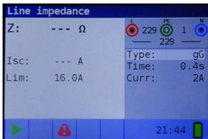
Imagen 5.35: Menú para medir la impedancia de la línea
