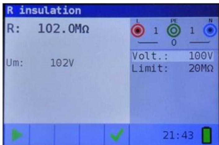
Imagen 5.3: Ejemplo de medición de la resistencia del aislamiento
