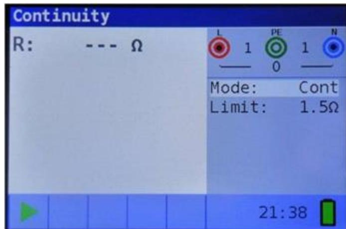
Imagen 5.8: Cables de prueba en cortocircuito
