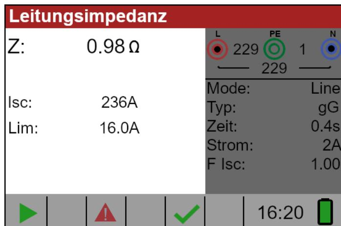
Bild 5.37: Beispiel für die Ergebnisse der Leitungsimpedanzmessung
