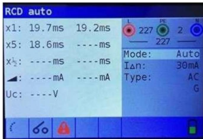
Imagen 5.22: Paso 3: resultados de la prueba automática de RCD
