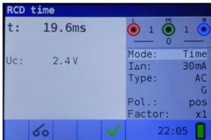
Image 5.16: Exemple de résultats du temps de déclenchement
