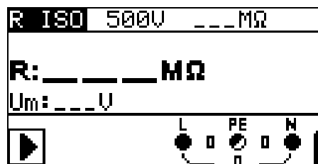
Figura 5.5: Resistencia de aislamiento
