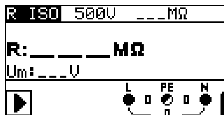
Figura 5.5: Resistenza di isolamento
