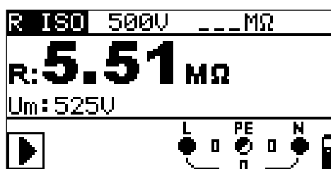
Rysunek 5.7: Przykładowy wynik pomiaru rezystancji izolacji
