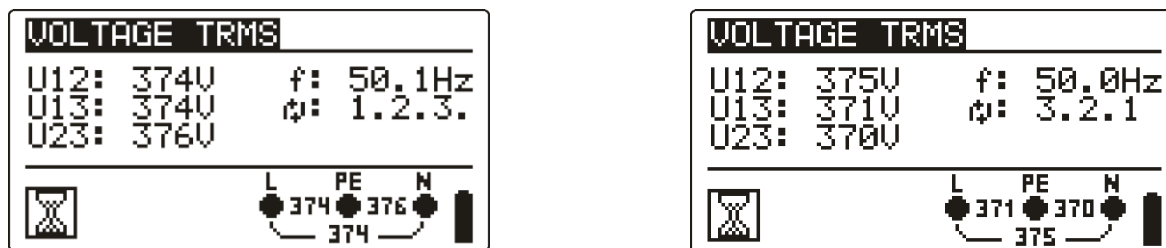
Figur 5.4: Exempel på spänningsmätning i trefassystem
