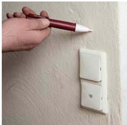
Mit dem Testboy 113 lassen sich auch unter Putz verlegte Kabel aufspüren. Offiziell besitzt das Gerät jedoch keine Eignung dafür.
