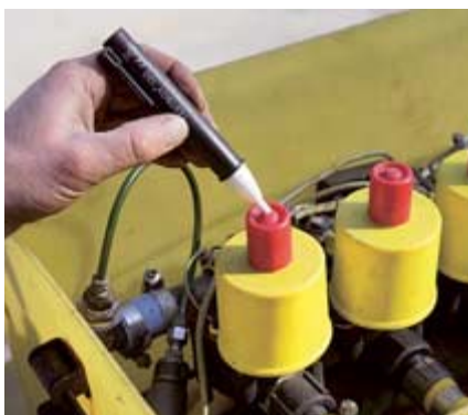
Ob 12- oder 24-volt, der Magnetfeldtester zeigt auch an Fahrzeugen und Geräten (hier Spritze) an, ob die Ventile arbeiten.
