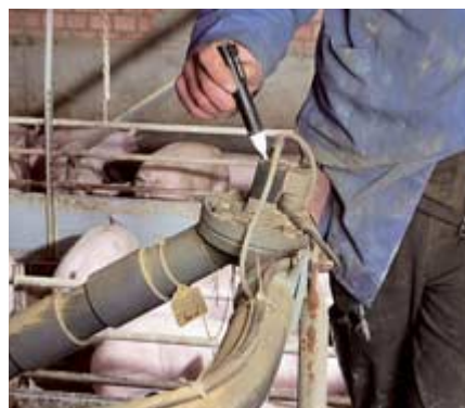
Wird das Futterventil angesteuert oder nicht? Der Magnetfeldtester zeigt sofort an, was Sache ist.
